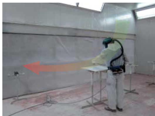
FIGUR 1. En arbejdstagers placering i sprøjtekabinen under sprøjtning og i forhold til luftstrømmen fra ventilationssystemet, der vises med pilen. Grøn angiver lavt antal NP, rød indikerer et højt antal nanopartikler.
