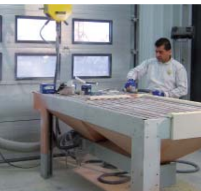
FIGUR 3. To eksempler på foranstaltninger til at undgå eksponering for fremstillede nanomaterialer under slibning og polering af materialer, der indeholder fremstillede nanomaterialer. Til venstre et arbejdsbord med vakuumudsugning; til højre optimal beskyttelse ved brug af nitrilhandsker, Tyvek-beskyttelsesdragt og åndedrætsmaske med FFP3-filtre.
