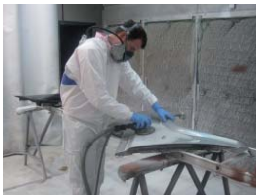
FIGUR 3. To eksempler på foranstaltninger til at undgå eksponering for fremstillede nanomaterialer under slibning og polering af materialer, der indeholder fremstillede nanomaterialer. Til venstre et arbejdsbord med vakuumudsugning; til højre optimal beskyttelse ved brug af nitrilhandsker, Tyvek-beskyttelsesdragt og åndedrætsmaske med FFP3-filtre.
